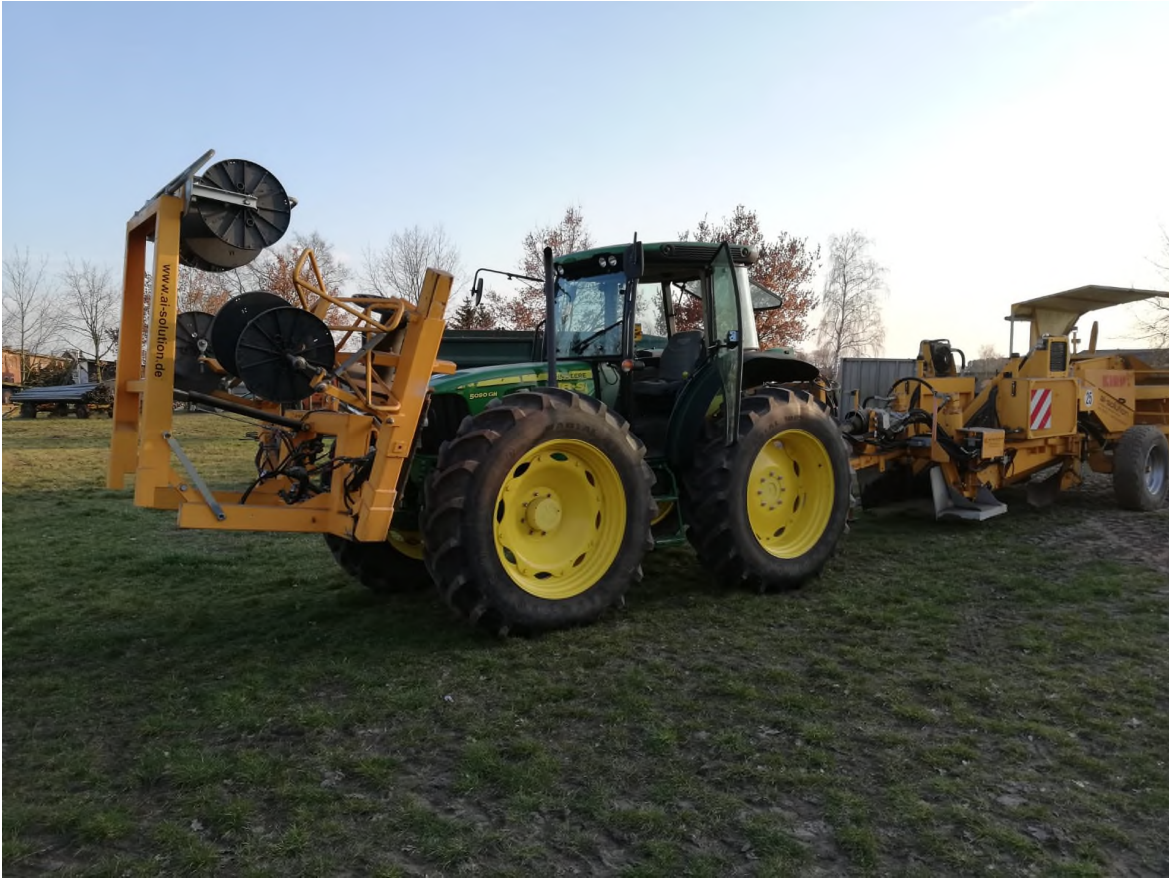
Kombination aus gezogener Kirpy und Folienverlegeeinheit
